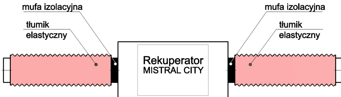
Podłączenie tłumików – model rekuperatora MISTRAL CITY z króćcami do boku (FH)
